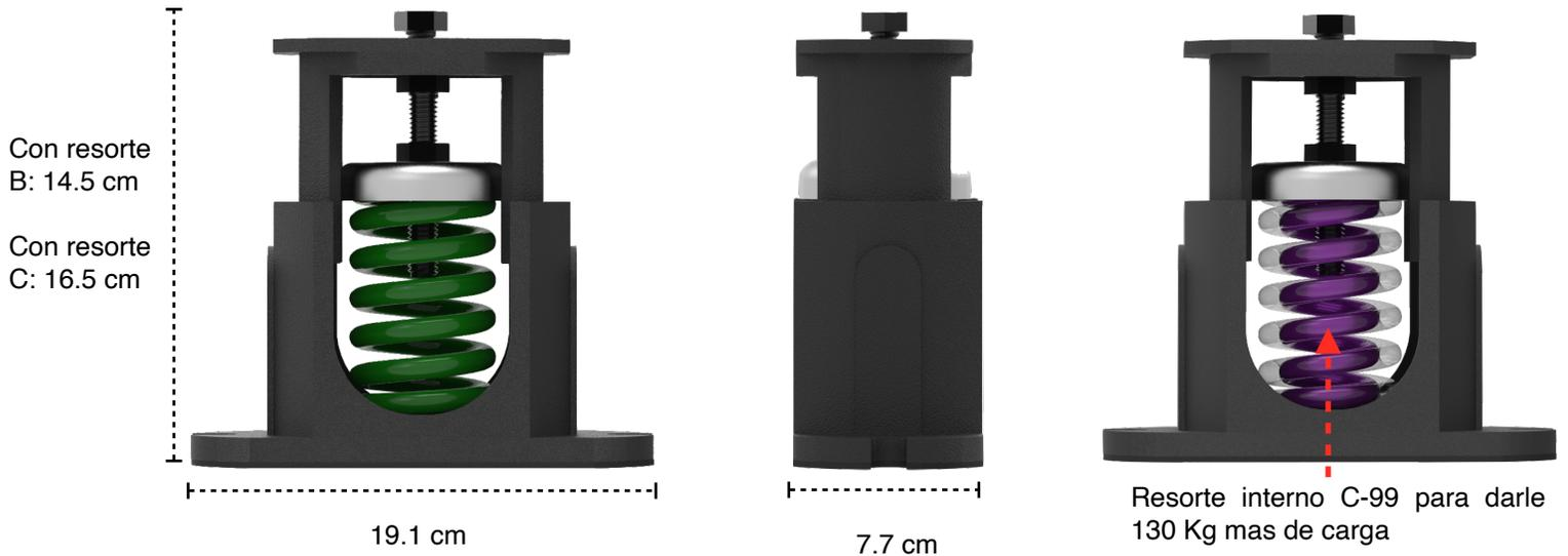
Los resortes que se usan en los soportes RSA, pueden ser de 3 tipos los "B", "C" y el "D". En los primeros "B" el peso máximo que pueden soportar es de 222 Kg. En los tipo "C" el peso máximo es de 440 Kg y en los "D" es de 828 Kg. Cuando se usen resortes tipo "C" o "D" y el peso nominal no sea suficiente se podrá colocar dentro de los resortes, los resortes internos "C99" que la da a cada resorte un soporte extra de 130Kg con la misma deflexión.
